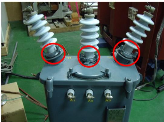
圖1 油浸式比壓器外觀
