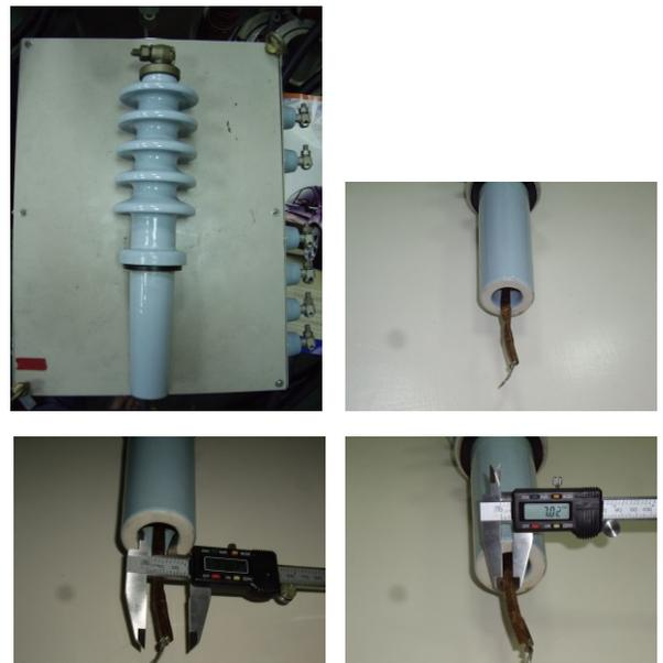
圖2 陶瓷套管外觀
