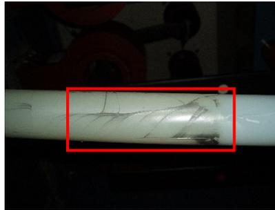
c. 半導膠帶施工錯誤的放電
