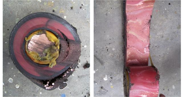
圖 10 局部放電源定位之電纜中間接續的解剖圖
