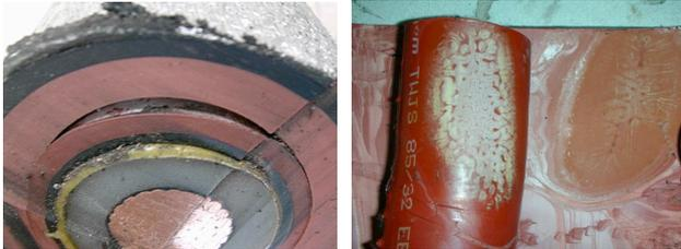
圖 8 電纜中間接續開解剖結果
