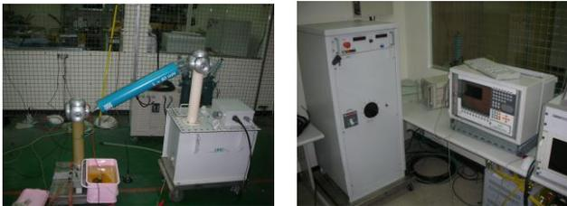
(a) 加壓設備、耦合設備及待試物 (b) 量測設備
