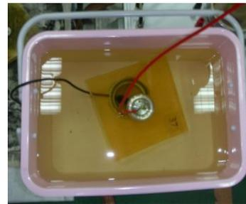
圖 6 試片擺置 (紅線為高壓導線，黑色為接地線)
