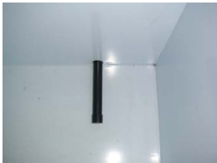
圖8 由洩油口佈置的VHF/UHF感應天線
