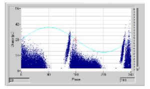
(d) Internal Discharge @ 6 kVRMS Fig. 2 PRPD Pattern at Different Test Voltage
